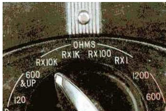
Posiciones destinadas a medida de resistencias en el selector de funciones.
