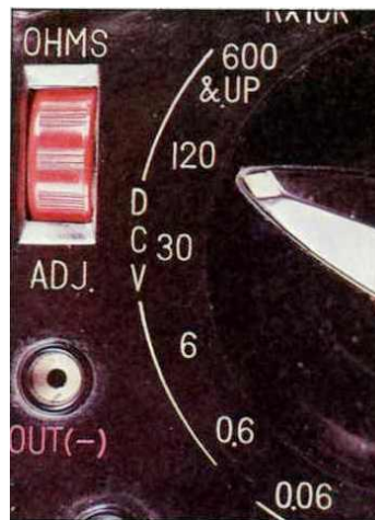
Posiciones de medidas de tensión continua DCV en un selector de escalas rotativas.
