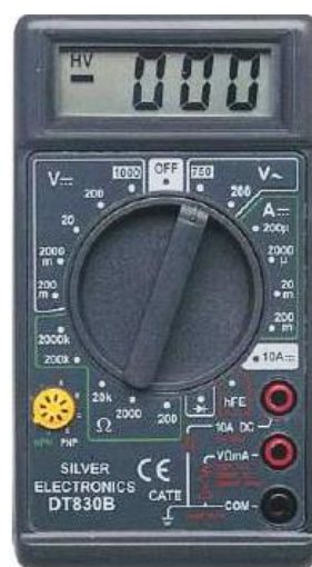
Polímetro digital portátil, con selector de escala rotativo y alimentación a pilas.
