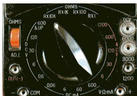
Selector de funciones, realizado mediante un conmutador giratorio.
